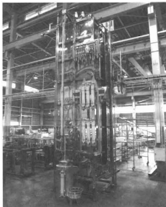
図4. 使用済制御棒切断装置
