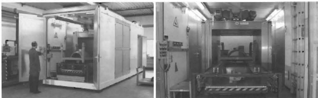
図3 可動型クリアランス計測設備
